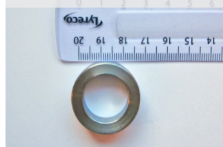
Distans till tångskruv Distance for Tong Screw
